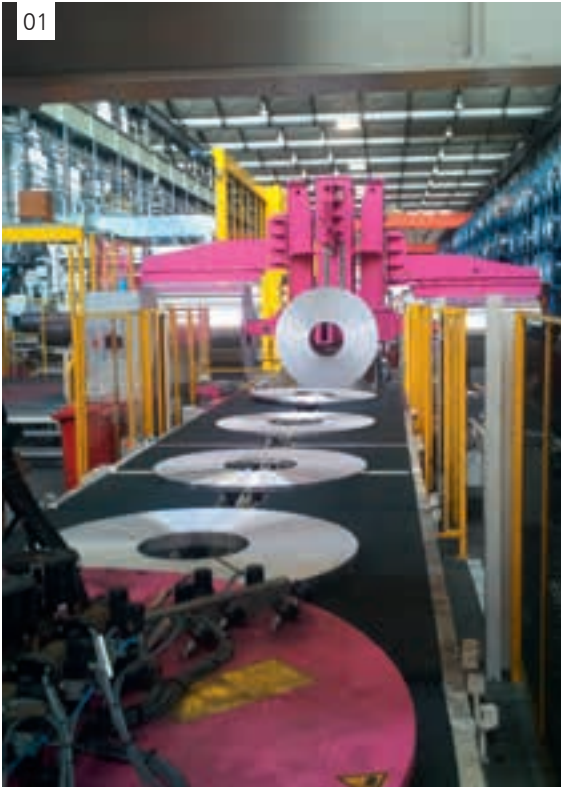
01, 02 Automatische Verpackungsanlage für Aluminium-Coils | Automatic packaging line for aluminium coils
