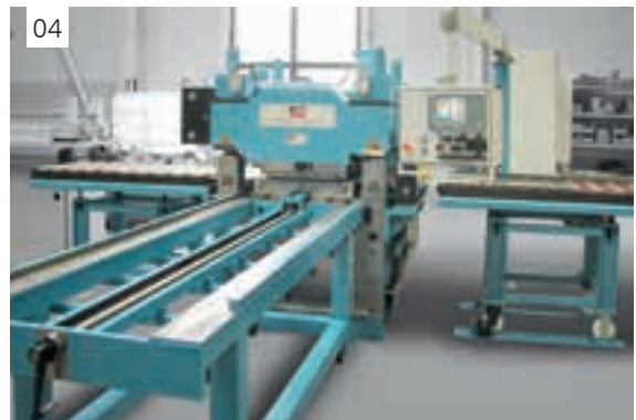
08 Schmalbandrichtmaschine für Teile und Bänder Narrow levelling machine for pieces and strips
