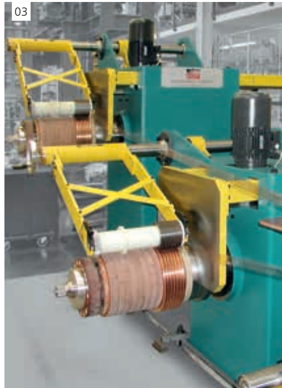
06 Aufwickelsystem mit automatischer Banddicken-kompensation | Recoiling system with automatic strip thickness compensation
