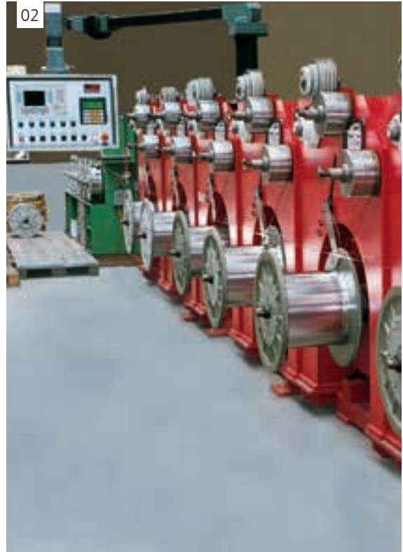
06 Längsteilanlage mit Mehrfachverlegespuler Slitting line with multiple traverse spooler: 0,15 – 0,5 mm x 50 mm, 100 m/min
